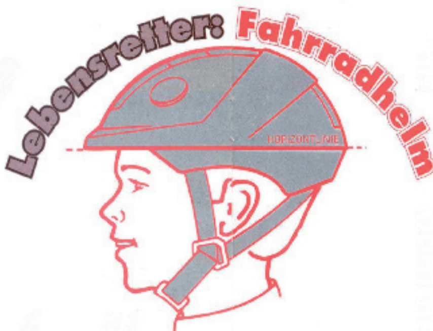
Perfekter Helmsitz und richtige Gurteinstellung: Der Helm sollte in der Hutkrenpennlinie sitzen und sich mit dem Finger nicht leicht wegschieben lassen. Helme sollten nicht älter als 6 bis 7 Jahre alt sein.
